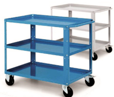
carrello a 3 piani con 4 ruote in gomma standard Ø 125 mm, fornito montato, portata: 300 kg colore blu ral 5012 - dim. mm 1024×615×847 h
